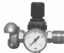
Druckminderer 0,5-3 bar Eingang = Kompressor-Klauenkupplung Ausgang = Euro-Einhandkupplung
